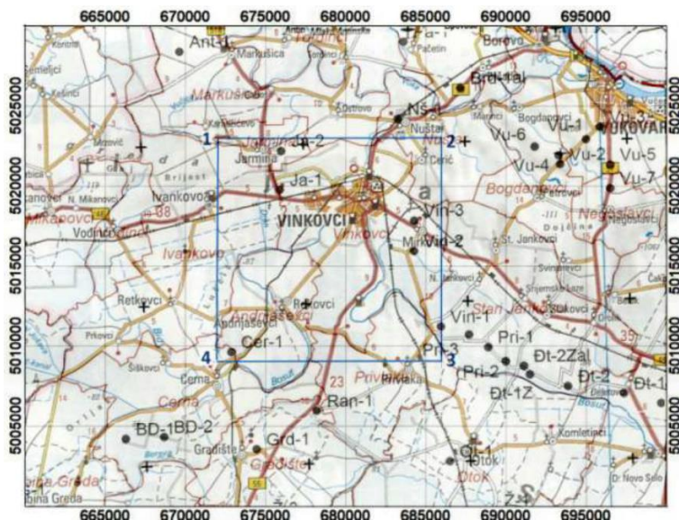
Slika 1.: Istražni prostor geotermalne vode „Vinkovci“, izdvojeno za potrebe definiranja potencijala geotermalne vode, s lokacijama dubokih istražnih bušotina na ugljikovodike i vodocrpilištem Kanovci.
