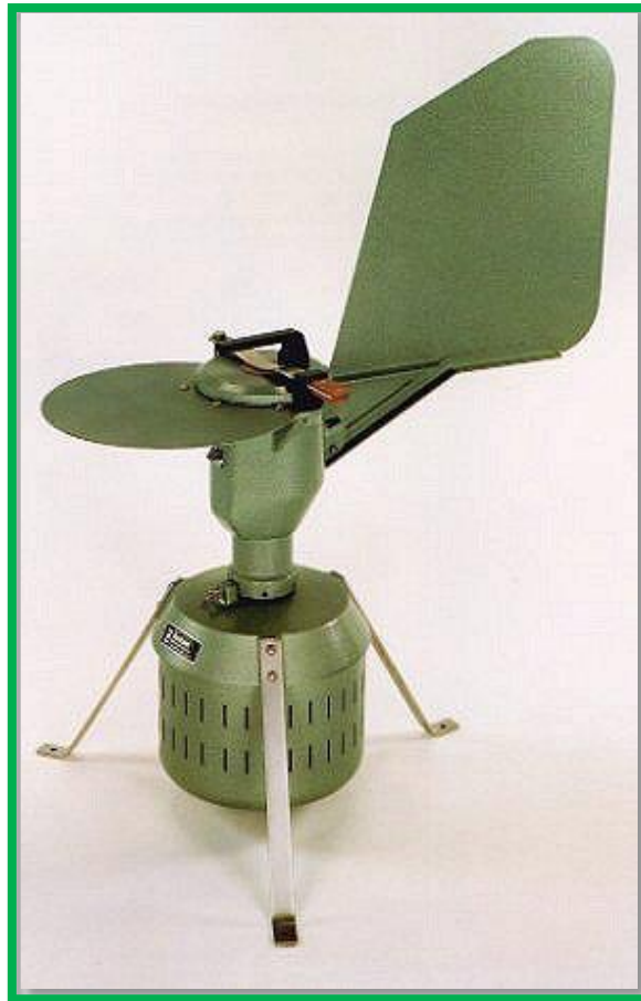
Slika 1. Klopka za pelud i spore „Burkard 7day volumetric spore trap“
