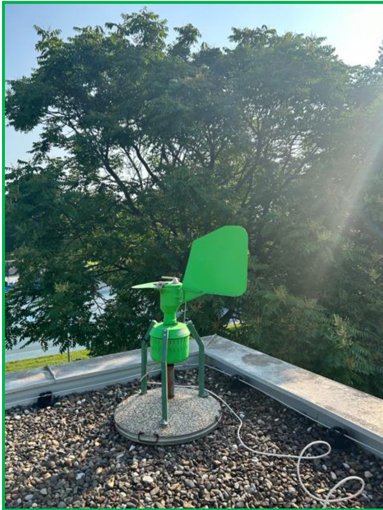
Slika 1. Klopka ze pelud i spore „Burkard 7day volumetric spore trap“ na krovu zgrade Gradskih bazena
