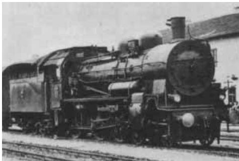
Brzovazna lokomotiva sustava «blizoz» na priprejenu paru se zaprežnim tenderom (animio T. Bratej)
